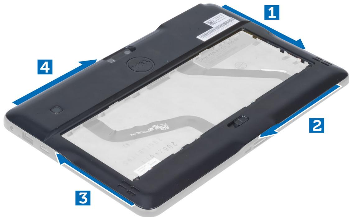
5. Haga palanca suavemente y levante hacia arriba las lengüetas que aseguran la cubierta de la base en el compartimento de la batería. Haga palanca y dé la vuelta a la cubierta de la base.
