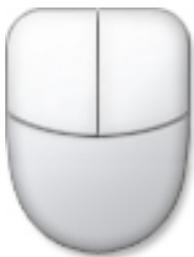
Cuando utiliza el **Modo Táctil**, una imagen translúcida de un ratón de computadora, llamado puntero táctil, flota bajo su dedo. El puntero táctil tiene botones de ratón izquierdo y derecho que puede utilizar con los dedos. Utilice el área debajo de los botones para arrastrar el puntero táctil.
